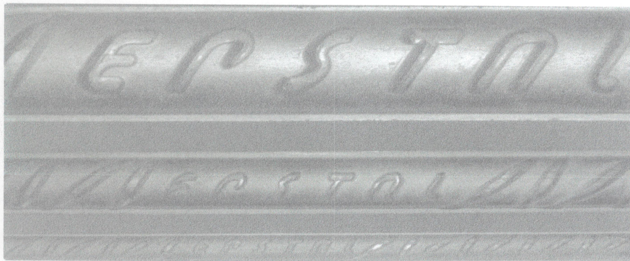
Obr.č.1 Obchodní označení oceli pro výztuž B500SP
